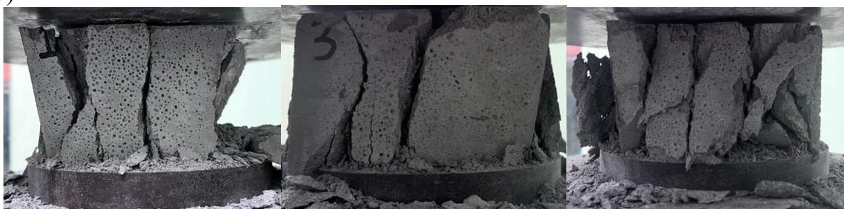
Рисунок П1.7 -Фото образцов группа 1 до (а) и после испытания на одноосное сжатие
