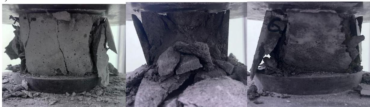
Рисунок ПЗ.7 -Фото образцов группа 3 до (а) и после испытания на одноосное сжатие
