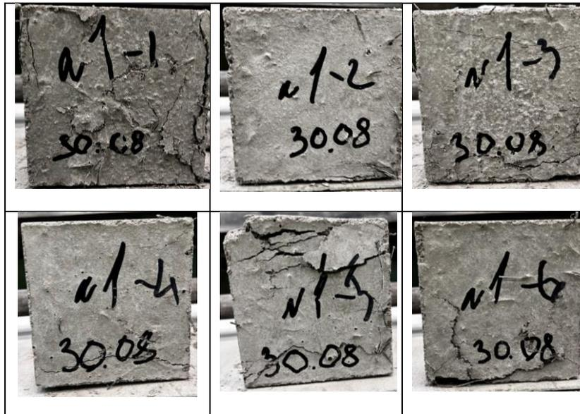
Рисунок П4.7 -Фото образцов группа 4 после испытания на одноосное сжатие
