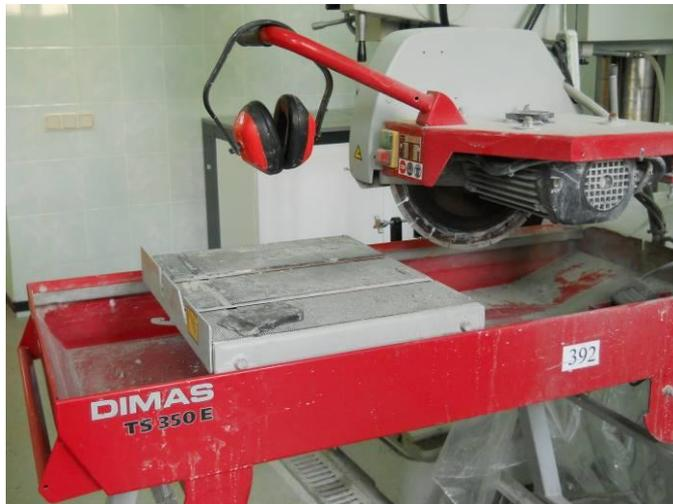
Рисунок 1– Камнерезный станок DIMASTS 350 E
