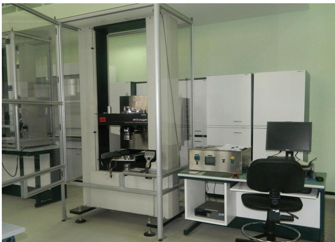
Рисунок 3- Испытательная машина MTS Insight 200
