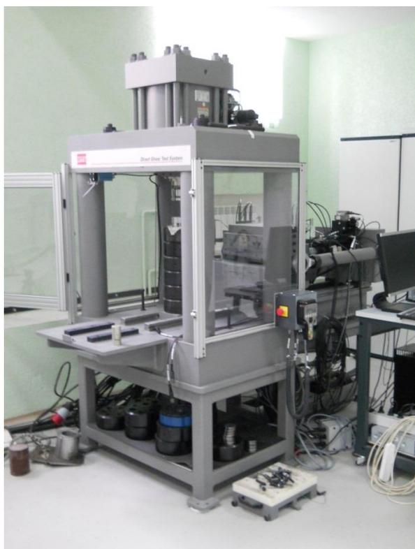
Рисунок 2 – Вид прессовой установки MTS 816.
